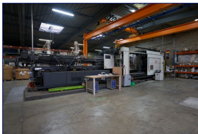
Inyectora termoplástico 1300 ton. Columna retráctil DEMAG Ergotech 1300-8000 Ref: 17923
